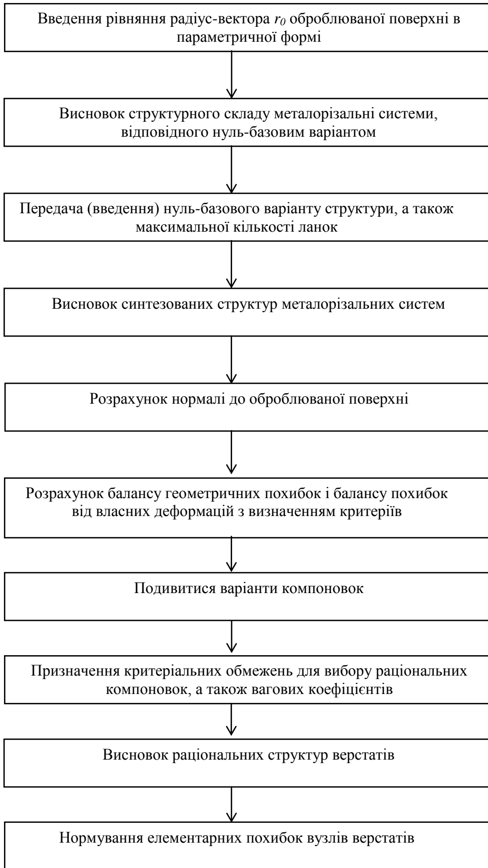
Рис.3.1 – Загальна схема алгоритму роботи системи синтезу та оцінки компонувань металорізальних верстатів
